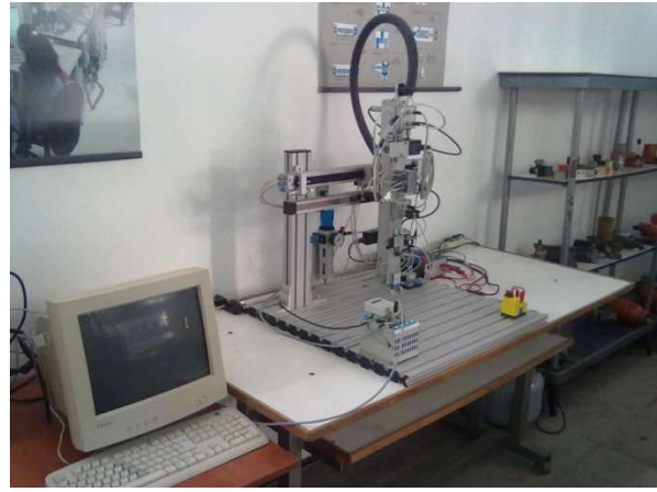
Stand FESTO pentru studiul unui manipulator pneumatic liniar cu automat programabil
