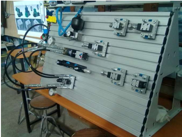
Stand FESTO pentru încercarea cilindrilor hidraulici, supapelor de siguranță, supapelor de reducere și reglatoarelor de debit
