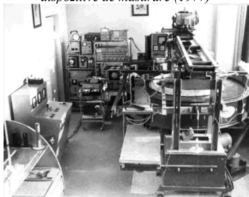
Instalație experimentală pentru studiul mișcării plane de rotație a apei
