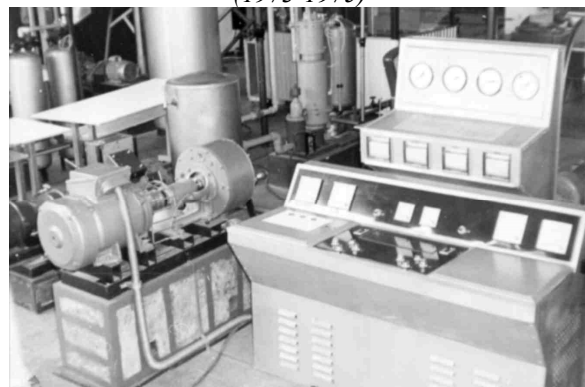
Stand pentru studiul uzurii hidroabrazive prin jet hidrodinamic
